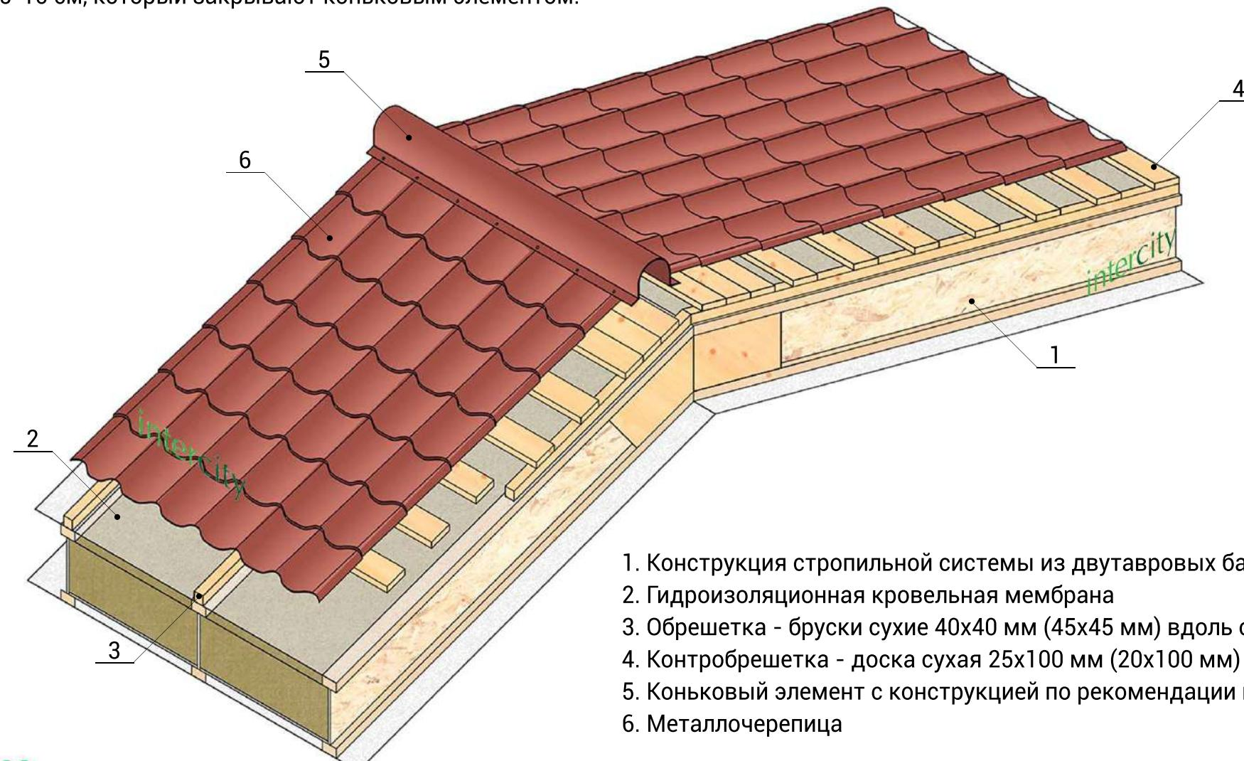
1. Конструкция стропильной системы из двутавровых балок с утеплением
