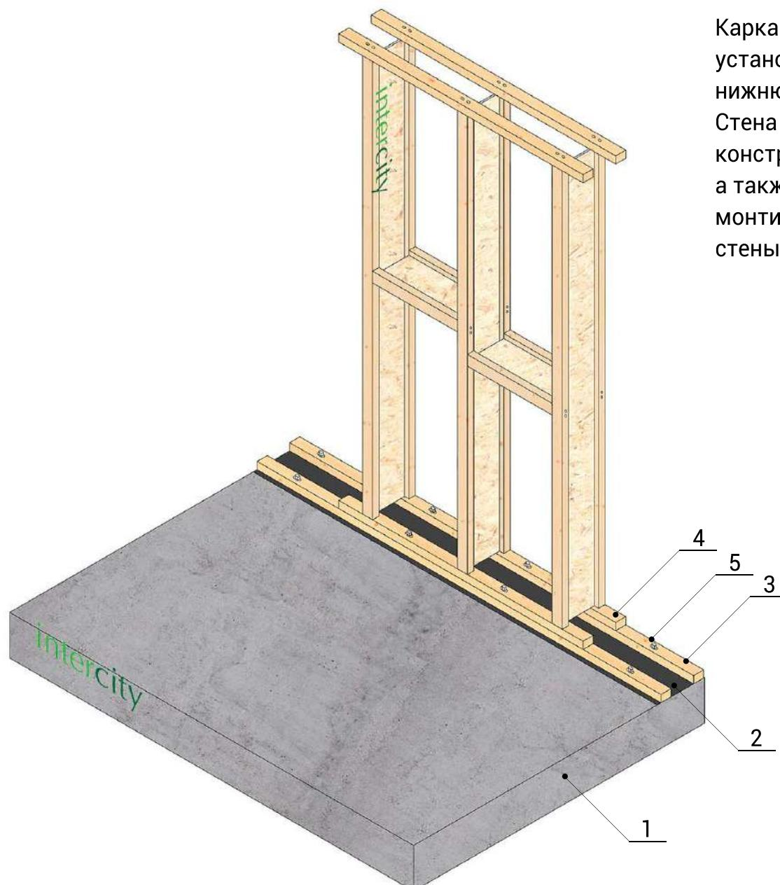
Каркас стен 1 этажа монтируется на предварительно установленную и выровненную по горизонтальному уровню нижнюю обвязку. Стена крепится к обвязочным брускам на саморезы конструкционные 80x5 (винтовые гвозди 85x4 мм) с шагом 500 мм, а также при помощи анкеров по бетону 190x16 мм. Анкера монтируются с шагом 800-1000 мм через нижнюю направляющую стены.
